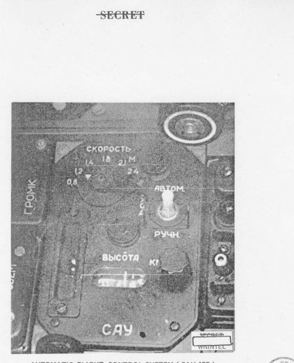
AUTOMATIC FLIGHT CONTROL SYSTEM ( SAU-155 ) MACH-HOLD PANEL
